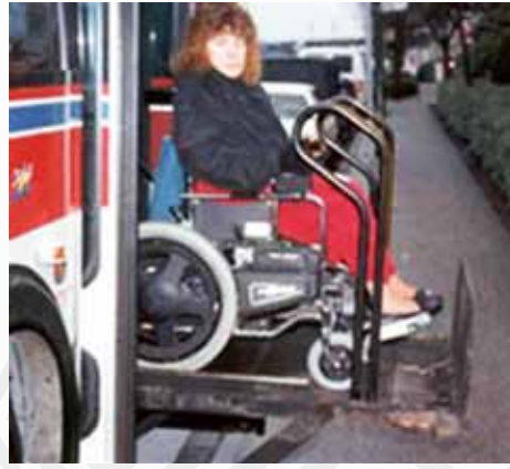
شكل ٦٩: حافلة نقل جماعي ذات أرضية منخفضة مجهزة بمصعد
