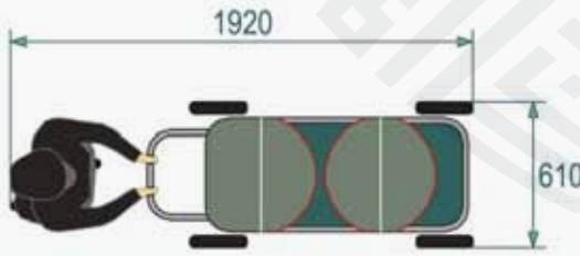
شكل ٣٤: الفراغ المطلوب لعربة يد ثنائية ترادفية
