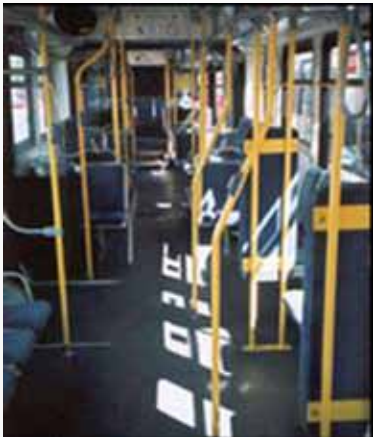
شكل ٩٦: حافلة مجهزة بدعامات ذات ألوان مميزة
