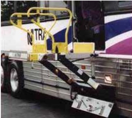
شكل ١٢٦: مصعد يمكن تخزينه بعد الاستعمال
