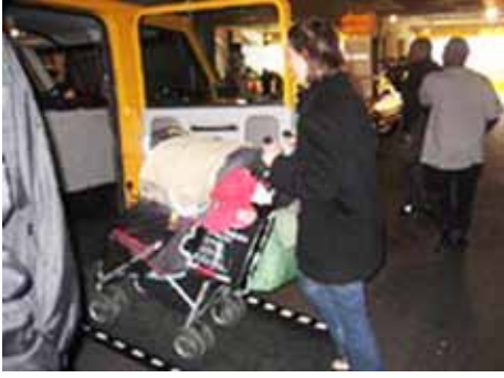
شكل ٥٢: سيارة أجرة نموذجية مزودة بسطحة لتمكين صعود العربات والكراسي المتحركة
