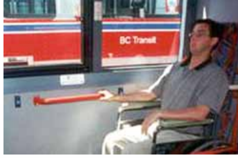
شكل ٦٢: درابزين في مستوى الكرسي المتحرك
