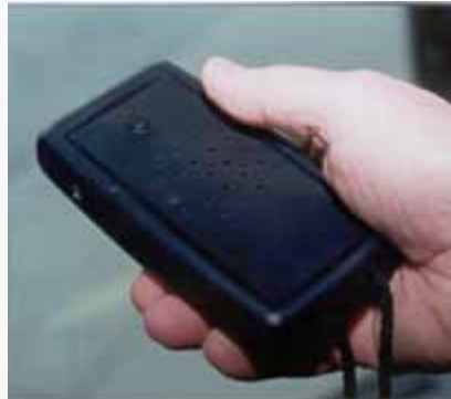
شكل ١٢١: أجهزة بث واستقبال للإشارات الصوتية المرسلة عن بعد بواسطة الأشعة تحت الحمراء
