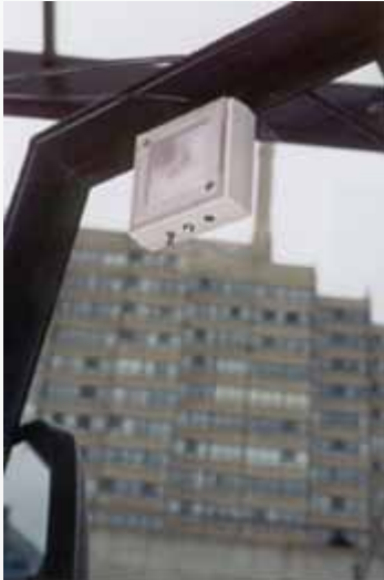
شكل ١٢١: أجهزة بث واستقبال للإشارات الصوتية المرسلة عن بعد بواسطة الأشعة تحت الحمراء
