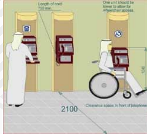
شكل ٤٥: صف هواتف سهلة الوصول مع هاتف عام واحد تم تركيبه على ارتفاع منخفض ليلائم الاشخاص في الكراسي المتحركة / السكوتر
