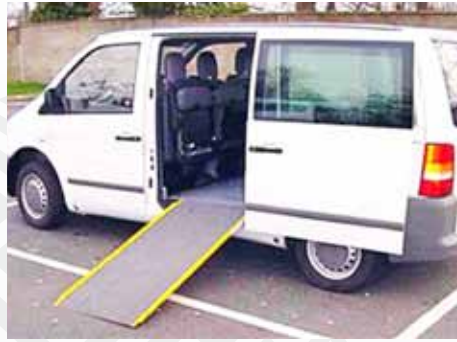
شكل ٥٣: سيارة أجرة من نوع فان مزودة بسطحة عند المدخل الجانبي لإركاب مستخدمي الكراسي المتحركة
