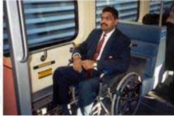
شكل ١١٢: مساحة مخصصة لاستيعاب كرسي متحرك وقد تم تثبيت كرسي قابل للطي فيها موقع لتثبيت الكرسي المتحرك مع الراكب في قطار للنقل المحلي (الدور الأرضي)
