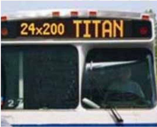
شكل ٤٢: المعلومات الخاصة بالمقصد او المسار معروضة على الجهة الخارجية للمركبة، لافتة ثنائي باعث الضوء (LED) بخط كبير و تباين لوني
