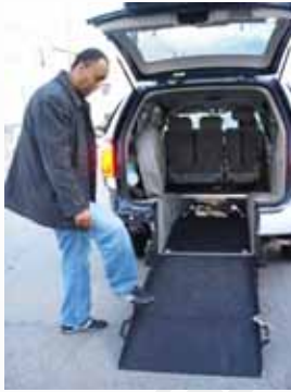
شكل ٥٤: سطحة للصعود إلى تاكسي مجهز لتسهيل الوصول عبر الباب الخلفي للمركبة
