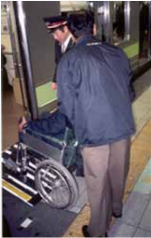
شكل ٩٩: منحدر يستخدم بشكل يدوي لتجسير الفجوة بين المنصة والقطار
