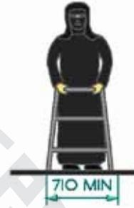
شكل رقم ١٠٥: الفراغ المطلوب لحركة شخص يستخدم مشاية
