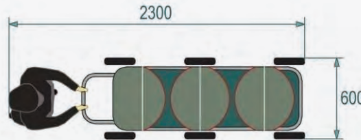
شكل ٤٤: مساحة أرضية خالية من العوائق لعربة يد ثلاثية ترادفية.
